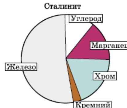
а) Вещество, имеющее в сплаве наибольшую массовую долю, называется *основой* сплава. Определите по диаграмме основу сталинита.
