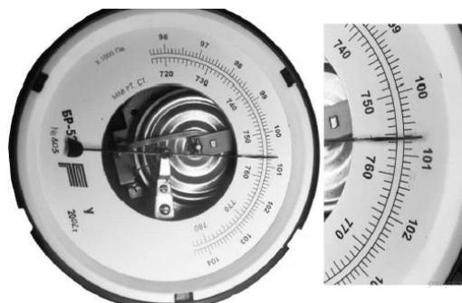
4. Запишите результат измерения атмосферного давления с помощью барометра-анероида (см. рисунок), учитывая, что погрешность измерения равна половине цены деления.
