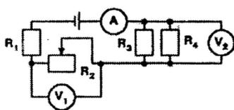
$$\begin{aligned} \text{ЭДС} &= 12,4 \text{ В} \\ r &= 0,2 \text{ Ом} \\ R_1 &= 2,9 \text{ Ом} \\ R_2 &= 1,6 \text{ Ом} \\ R_3 &= 6 \text{ Ом} \\ R_4 &= 2 \text{ Ом} \end{aligned}$$
